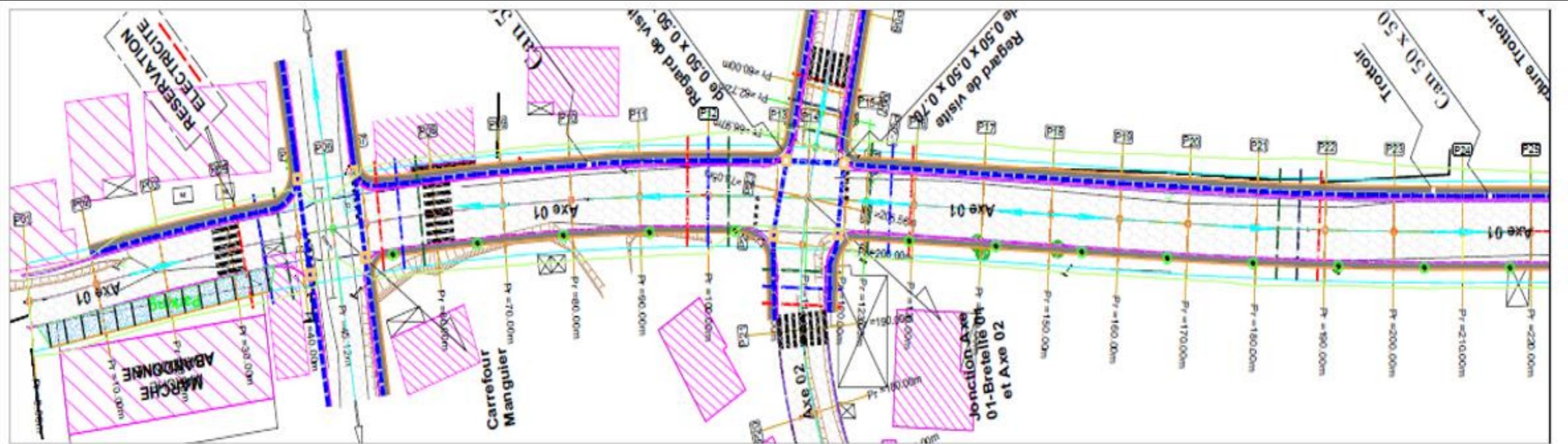
Figure 8 : réservation des conduites pour le passage des réseaux
